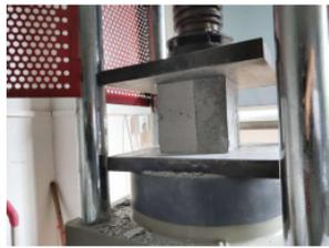
图 6 模拟构件结合面受力性能试块试压过程
