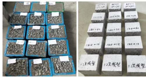
图4 构件分层厚度对比试块
