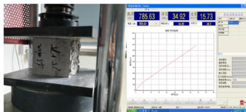
图5 试块结合面试压过程
